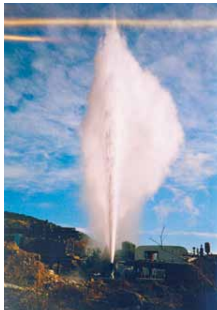
Η γεωθερμική παραγωγική γεώτρηση στον Ακροπόταμο Καβάλας έχει βάθος 275 μ. και παράγει, με αρτεσιανισμό (150 m 3 /h), νερά θερμοκρασίας 83°C με σημαντικές ποσότητες διοξειδίου του άνθρακα
